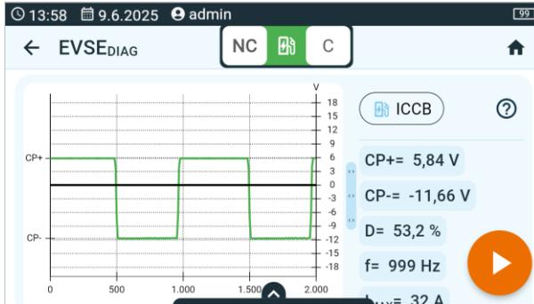
**CP+, CP-** – Die Spannungen der gemessenen CP-Signalverläufe werden relativ zum Referenzwert angegeben. Dadurch kann die Korrektheit der Kommunikation zwischen EVSE und dem angeschlossenen Fahrzeug bewertet werden.
